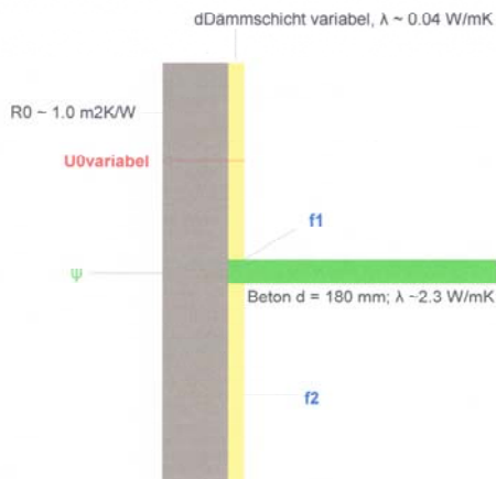
Bild 1: Schemaschnitt Wärmebrücke mit Festlegungen
